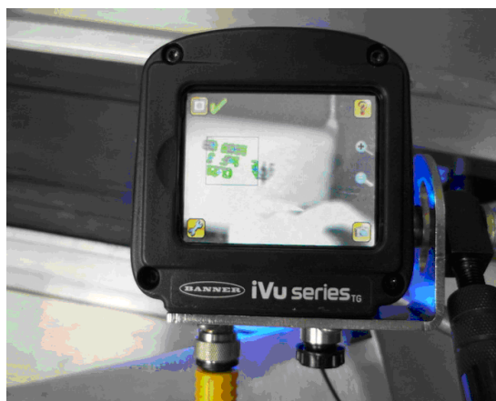
图 7：iVu 视觉传感器检测电子元件表面是否印字
